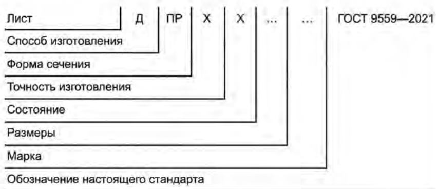
Рисунок 1 — Схема условного обозначения листов
